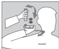
Per ottimizzare la portata far ruotare lentamente l'ARVA attorno ai suoi assi. Tenere l'apparecchio lateralmente alla testa con l'altoparlante girato verso l'orecchio.
