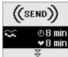
In caso di seppellimento (o in qualsiasi altra situazione di assenza di movimento) l'apparecchio registra la durata del seppellimento e capta i segnali vitali. Questi appaiono sia sull'apparecchio del seppellito che su tutti gli apparecchi in grado di ricevere i segnali vitali trasmessi per interfaccia via radio (W-Link). Faccia riferimento alle informazioni contenute nel capitolo «Durata del seppellimento e segnali vitali».
